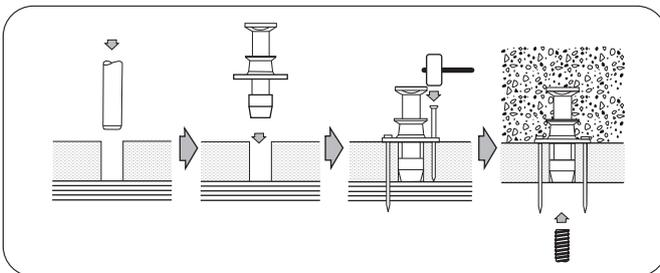
1. スライダートポンチで断熱材に穴をあけます。(垂直にひねり込んで下さい。)
