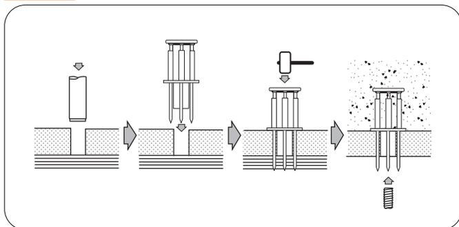
1. スライダートポンチで断熱材に穴をあけます。(垂直にひねり込んで下さい。)
