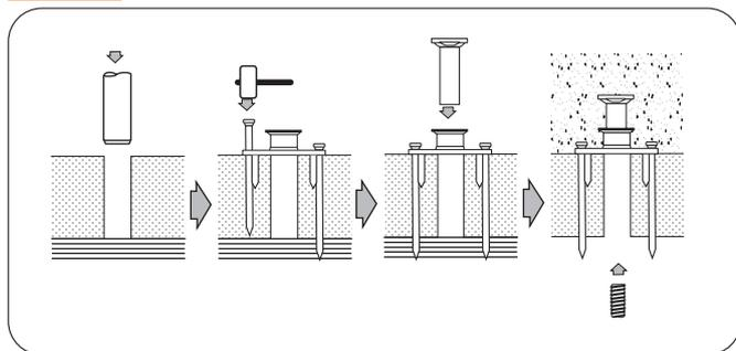
1. スライダートボンチで断熱材に穴をあけます。(垂直にひねり込んで下さい。)
