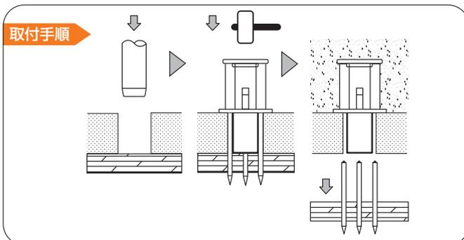
1. スライダートレンチで断熱材に穴をあけます。(垂直にひねり込んで下さい。)
